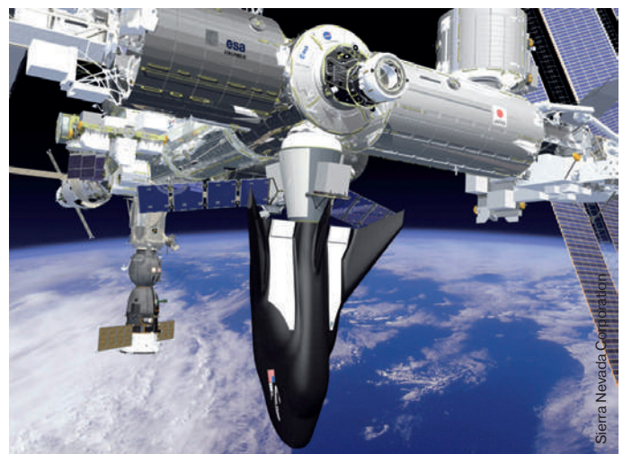
▲ Предполагаемый вид корабля Dream Chaser, пристыкованного к МКС, без одноразового грузового модуля (с которым аппарат будет запускаться в первых полетах)
