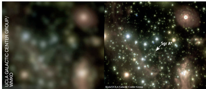
▲ Пара снимков области неба в окрестностях направления на центр Млечного Пути, сделанная телескопами Кекс (обсерватория Мауна Кеа, Гавайские острова). Справа — изображение, полученное с использованием системы адаптивной оптики, слева — без нее. Положение центральной сверхмассивной черной дыры (радиоисточник Sgr A*) показано стрелкой.
